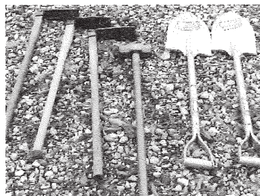
掘削作業及び杭打工具
