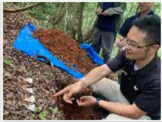
試薬を使い土壌のアルカリ濃度などを測る。
