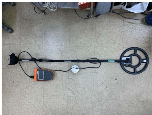
図4.4. 大型電子タグリーダー。Biomark社HPRplus。円形部が探知アンテナになっており、電子タグがアンテナ部に近づくとも15桁のIDが本体ディスプレイに示される。泥水・土中など目視できない場合でも、カエルの居場所を検知できる。
