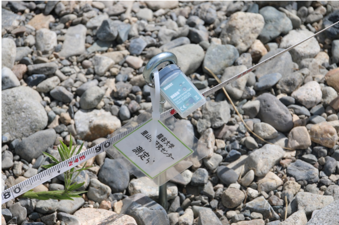
写真4 温度・照度ロガー設置の様子
