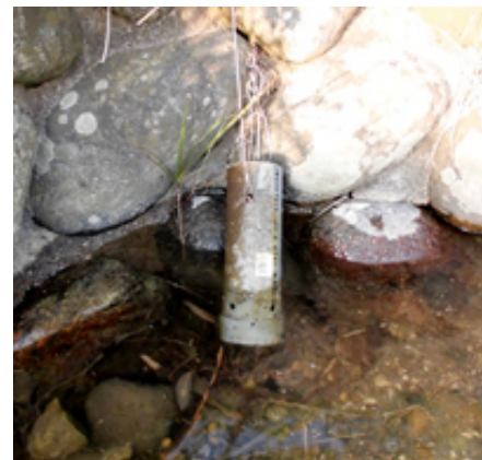
図10 継続的水温測定装置 左 計測装置の加工の様子 右 設置・測定の様子
