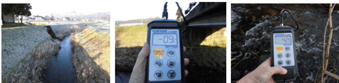
図12 厳冬期早朝の水溫等測定の様子 温度計は、CUSTOM CT-450WRを使用
