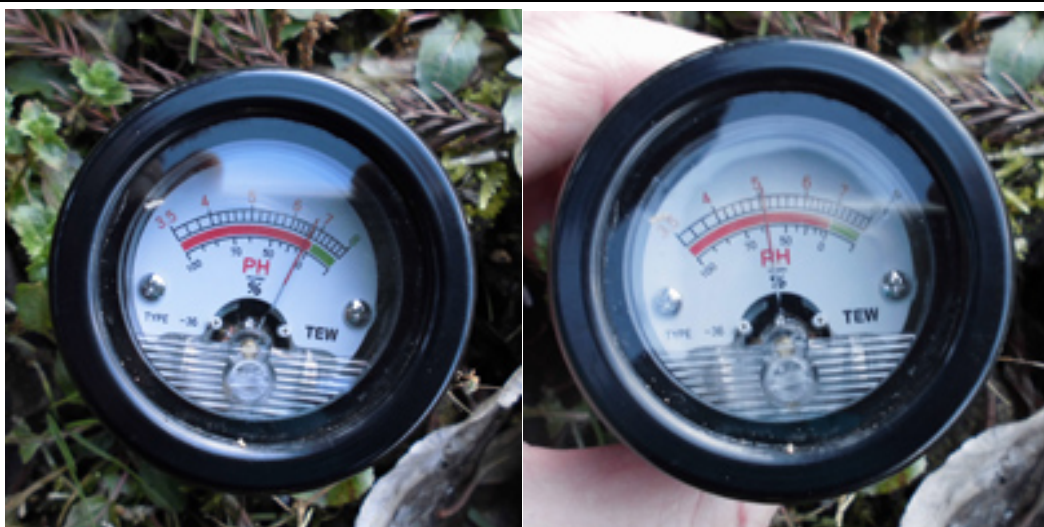
図5 DEMETRA DM-5 による測定(平成31年1月13日) 左 土壤pH 右 土壤湿度
