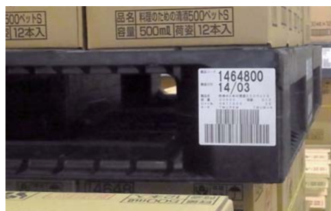
パレットに貼付したバーコードによる製品情報管理
