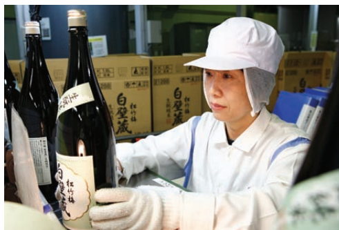
検査員による充填後の目視検査
