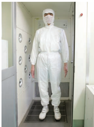
エアシャワー室での異物除去
