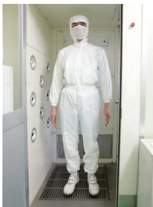
エアシャワー室での異物除去
