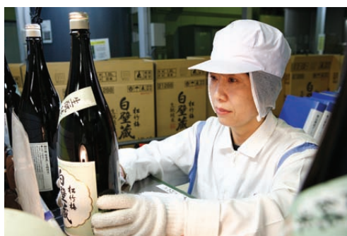
検査員による充填後の目視検査
