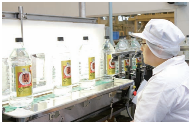
ボトルング時には、最新鋭の機械での検査に加え、人の目で最終チェックを行い、万全を期しています。
