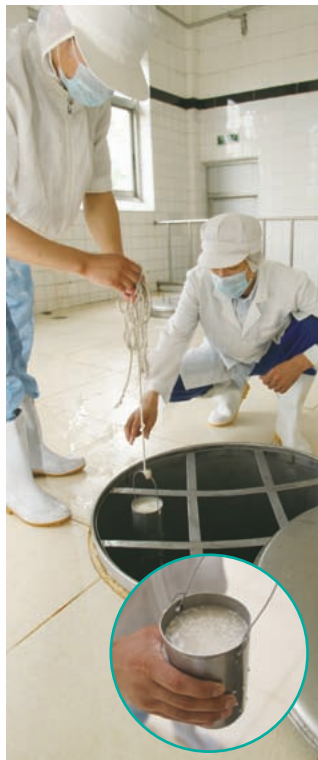
麴造りや発酵でもっとも重要なのは温度管理。機械でコントロールするだけでなく、人の五感も使ってでき具合を観察しながら温度を微調節していきます。
