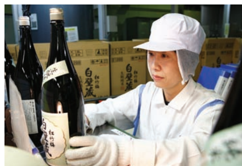
検査員による充填後の目視検査
