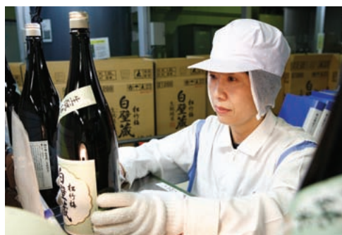
検査員による充填後の目視検査
