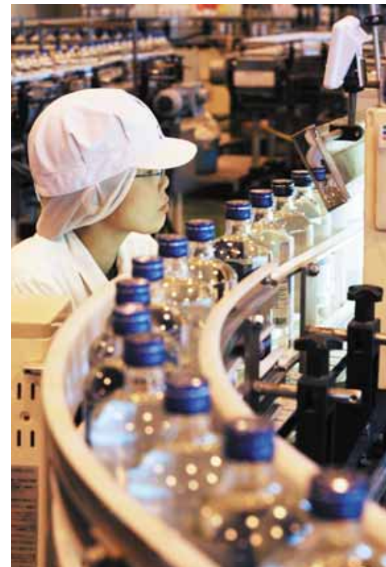
検査士による目視検査
