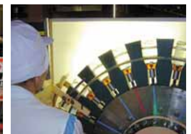
【目視検査】容器を回転させ、液もれや容器のキズなどが目視で検査している様子
