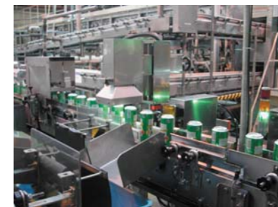
缶製品の自動検査の様子
